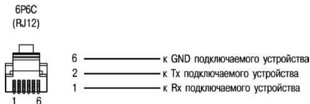
Рисунок В.3 – Схема кабеля для подключения ПЛК73 к порту RS-232
